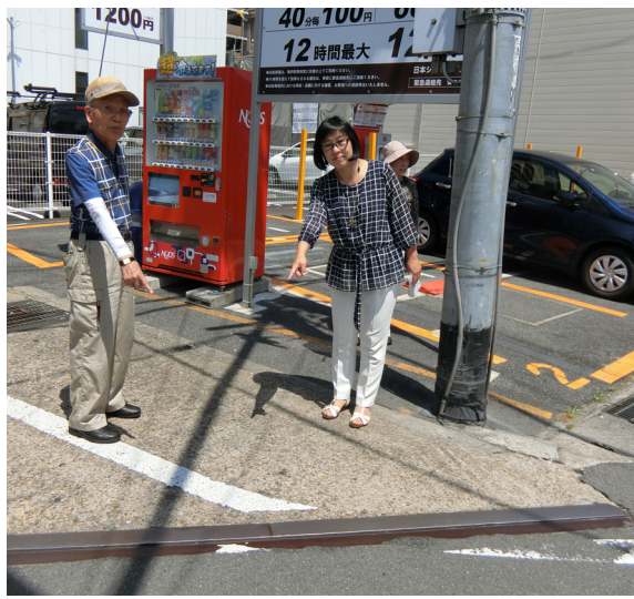
↑ 道路の端まではみ出している鉄板の部分。雨で濡れると滑りやすくなり、自転車で走行中に滑ってこけてしまった方もあるそうで、危険です。
